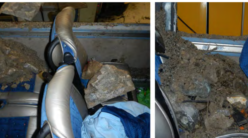
Bild 3. Bilderna visar platsen långt bak i bussen (oftast säkraste platsen) där en ung kvinna dödades av flygande stenar i busskraschen i Tranemo. Bussen körde i diket och välte i cirka 100 km/tim. (Bild från Statens haverikommissionens rapport 2015).
