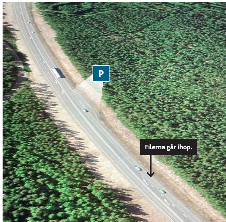
Bild 1. Platsen för dödsolyckan. 2 Avståndet från platsen där filerna går ihop till parkeringsfickan är cirka 50 meter, det vill säga 1,5 sekunders körtid i 110 km/tim.
