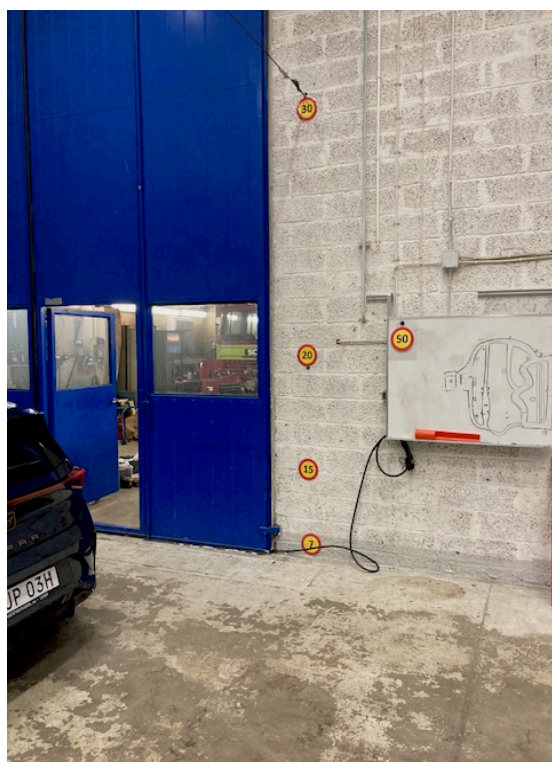
Bild 5. Bilden visar vilken hastighet en viss fallhöjd genererar; 2, 15, 20 km/t plus 50 km/t - vars skylt hade fått sättas vid sidan för annars skulle den ha hamnat ovanför taket (10 meter upp). 40 meter dvs. från ett tolvvåningshus ger 100 km/t – tänk på det när du kör 100 km/t!
