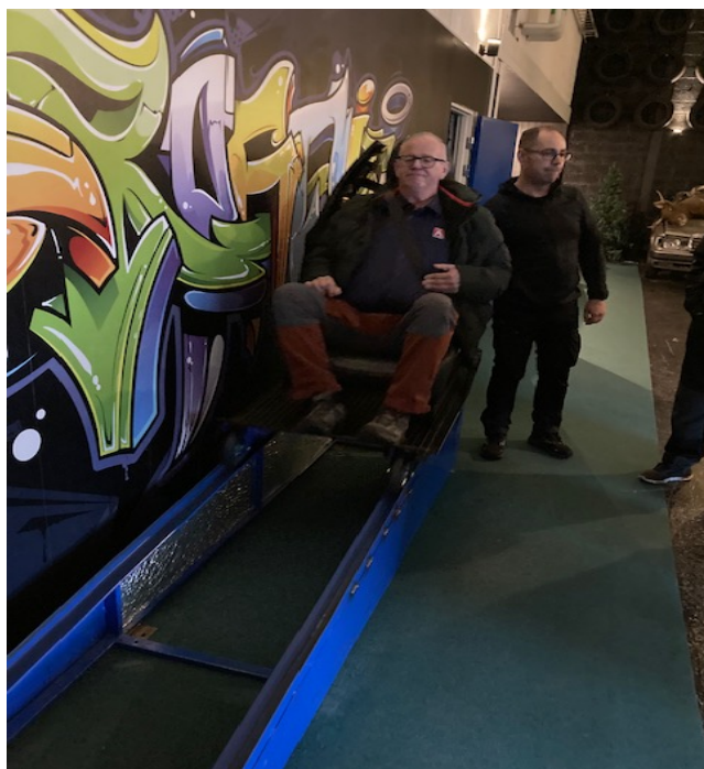
Bild 3. Krocksläden illustrerade hur ett abrupt stopp från 7 km/t kan kännas. Pär Erickson före start till vänster och Christer Nyberg efter stoppet till höger – bägge glada och nöjda att bältet fungerade.
