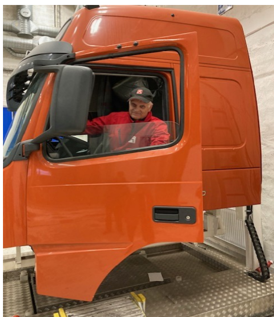
Bild 2. Christer Nyberg provar välthyttan för lastbil. Om man hamnar på sidan (roll 90 grader) med dörren blockerad, är det långt upp om man vill ta sig ut genom andra dörren – känns svårare än man kan tro.
